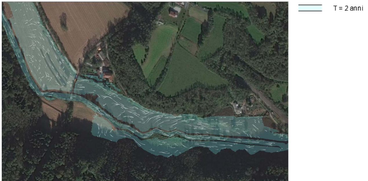
Figura 33 – Planimetria degli allagamenti stato di fatto T=2 anni con frecce di direzione e velocità della corrente
