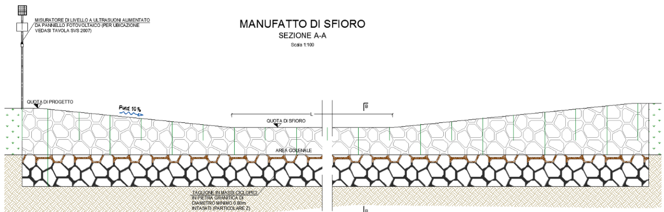
Figura 12 – Sezione tipo longitudinale dello sfioratore di alimentazione delle aree golenali
